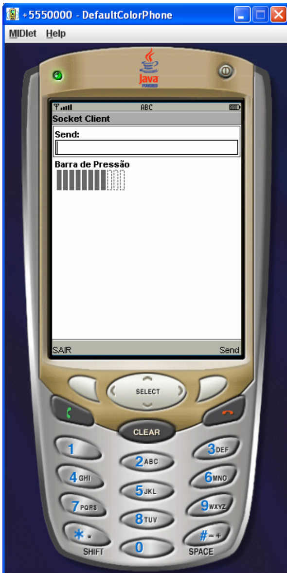
Fig. 22: Imagem do emulador do ambiente de desenvolvimento Netbeans a mostrar a monitorização de sinal de um sensor de força usando a aplicação em J2ME para o PDA.
